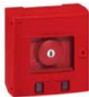
Ces derniers seront à contact "ouvert-fermé" pour combinaison dite "arrêt d'urgence" avec verrouillage préparé en position repos, chacun équipé de 2 voyants (vert & rouge). De plus ils seront de type coup de poing à accrochage, déverrouillage par clé n° 850.
